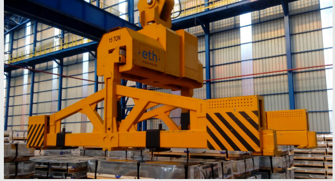
Kolları Motorlu Uzayabilen Paketli Levha Sac Taşıma Ekipmanı
