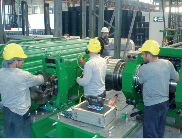
Kaplin Ayarı Yapılması
